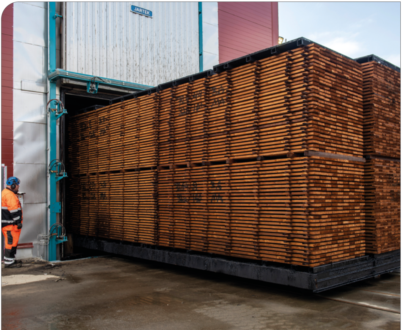
Kuva 4. ThermoWood®-lämpöpuuta valmistumassa prosessiunista.
